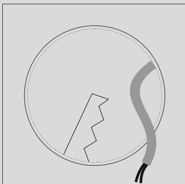
3 Для подключения используем контакт COM- и контакт выбранной мощности 3 Вт или 6 Вт. Зафиксировать очищенные контакты в клеммном терминале винтом.
